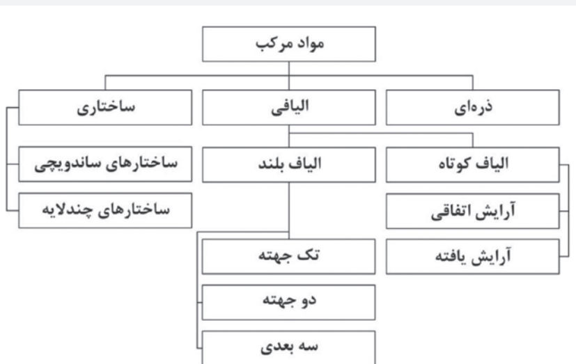
شکل ۱: دسته بندی انواع مواد کامپوزیتی بر اساس شکل و نحوه توزیع فاز مقاوم‌ساز [۱].
