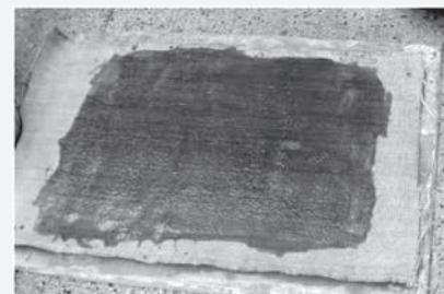
شکل ۳: نحوه آغشته‌سازی نمونه پارچه‌ها با رزین برای تولید نمونه‌های کامپوزیت
